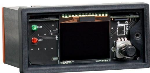
Obr. 7: EOR-1DS s demontovaným předním panelem pro přístup k SD kartě
